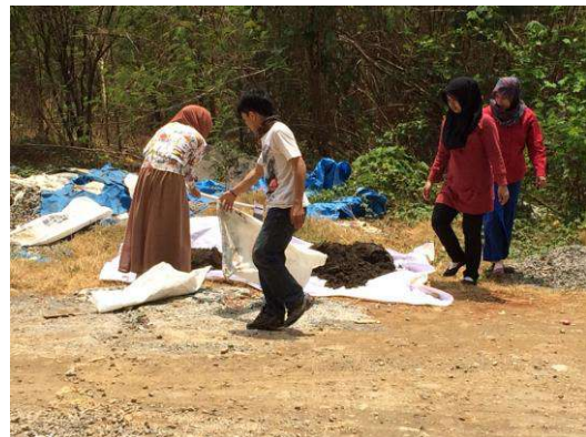
Proses pengeringan agregat
