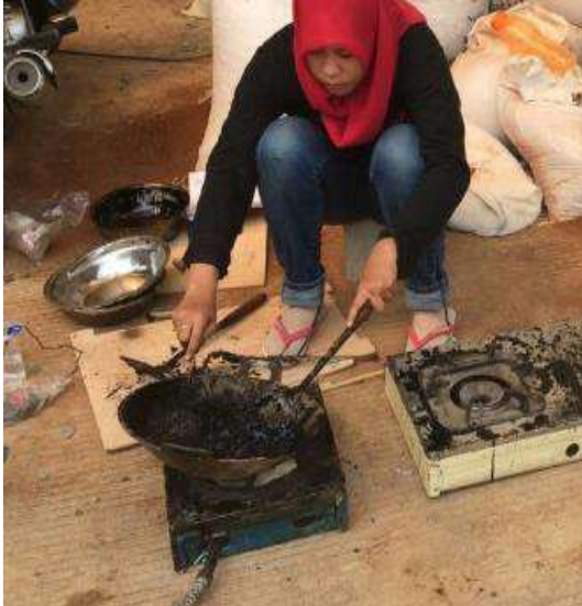
Proses Pemanasan Agregat dan Aspal Minyak
