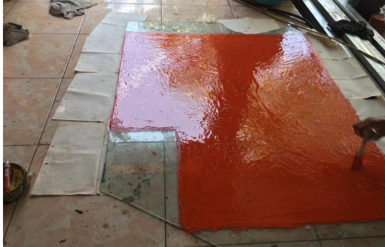
Proses penyapuan gel pada serat fiberglass
