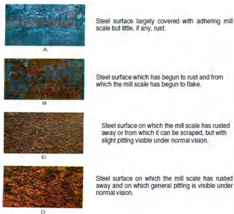
Gambar 2 - 6 Klasifikasi Permukaan Pelat Baja Sebelum Coating
