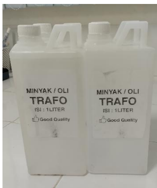
Gambar 25 Minyak Trafo Mineral
