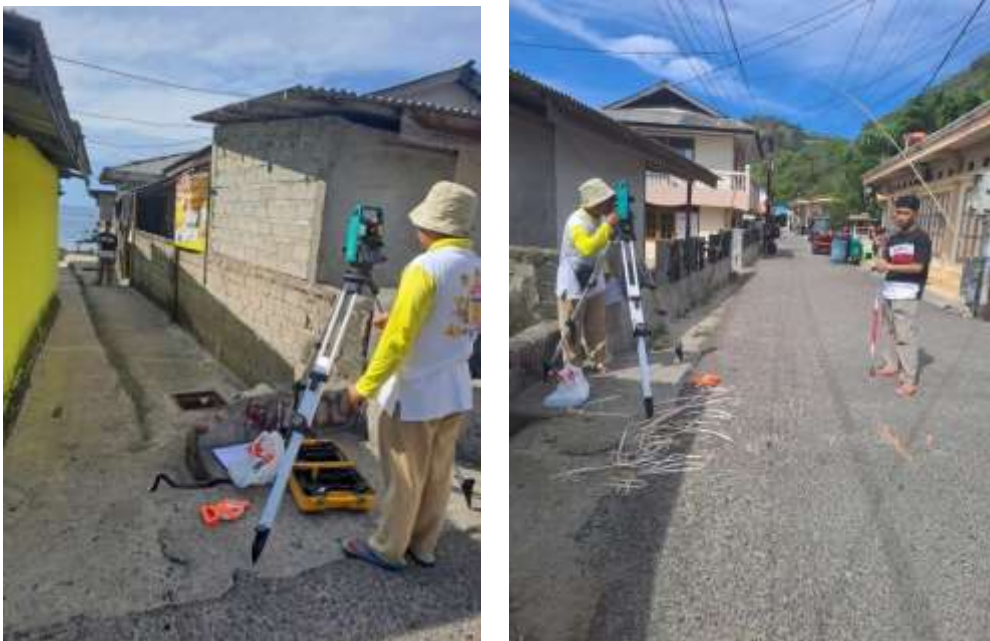
Gambar 2. 16. Pengukuran di lokasi penelitian dengan menggunakan alat Total Station (TS) digital
