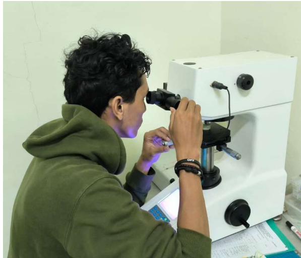
Gambar 8. Pengujian Microhardness Vickers. Sumber : (Lab. Metalurgi fisik)
