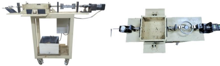
Gambar 10. Alat geser langsung yang telah di Modifikasi
