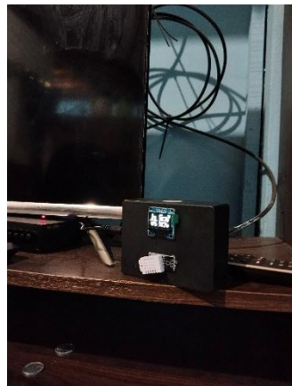
Pemasangan alat sensor DHT22/BME280 berbasis Internet of Things untuk mengukur suhu dan kelembapan
