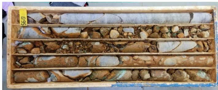
Gambar 2. 3 Data drillhole yang dibagi setiap 1 meter
