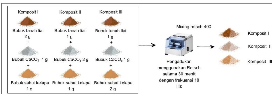
Gambar 2. Persiapan sampel bahan adsorben komposit dari tanah liat, \text{CaCO}_3 , dan sabut kelapa menggunakan perangkat filter.
