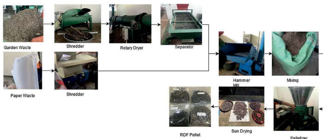
Gambar 3. Proses pembuatan pelet dengan berbagai macam sampah kertas dan sampah kebun (Suryawan et al., 2022)
