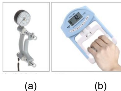
Gambar 2. 8 (a) Jamar Dynamometer ; (b) CAMRY dynamometer (Huang et al., 2022).
