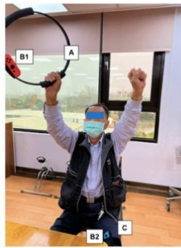
Gambar 2. 10 Komponen Nintendo Switch , untuk memainkan RingFit Adventure , pemain harus menggunakan Nintendo Switch , yang mencakup perangkat berikut ini: A. Ring-Con : Cincin Pilates yang dipegang pengguna; B. Joy-Con : Pengontrol nirkabel. Salah satu Joy-Con ( B1 ) harus diletakkan di atas Ring-Con (A). Joy-Con lainnya ( B2 ) harus dipasang pada Leg Strap ( C ) di paha pemain (Tuan et al., 2022).
