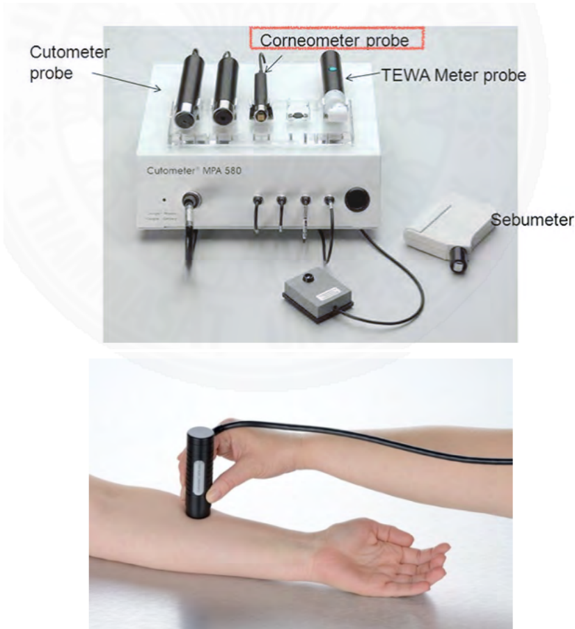
Gambar 1. 3. Probe Pengukur Hidrasi dari Corneometer
