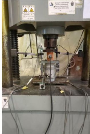
Gambar 4 Pengujian kuat tekan beton
