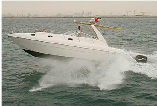
Gambar 1 Kapal tipe planing hull dalam mode gerakan planing Sumber: Yousef et al., 2013.
