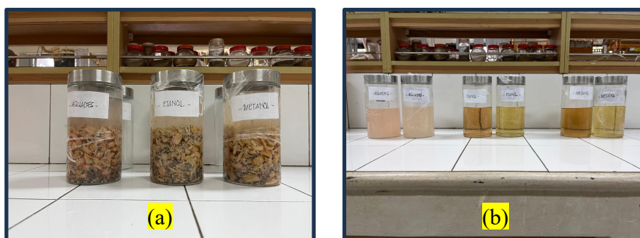
Gambar.3: (a) Proses Maserasi menggunakan Aquades, Etanol dan Metanol (b) Ekstrak Maserasi Aquades, Etanol dan Metanol
