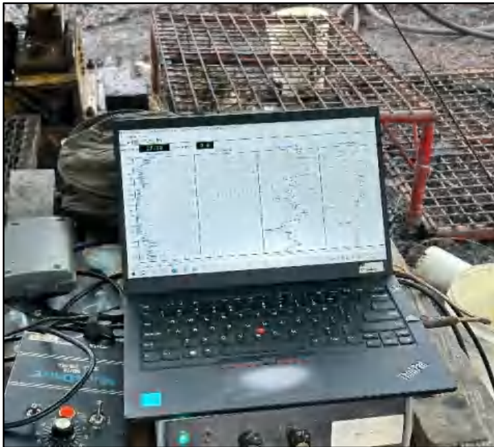
Gambar 19 Proses logging geofisika
