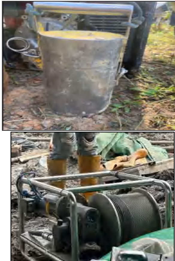
Gambar 21 Sumber radioaktif (kiri) dan winch cable (kanan)
