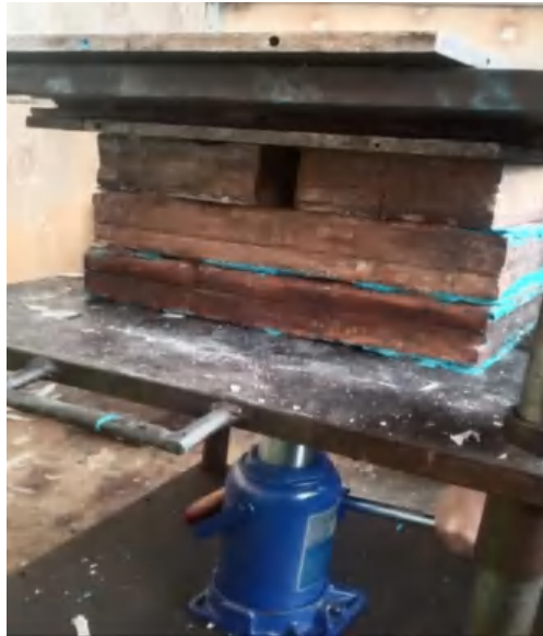
Gambar 14 Tahap perekatan menggunakan mesin hedrolik
