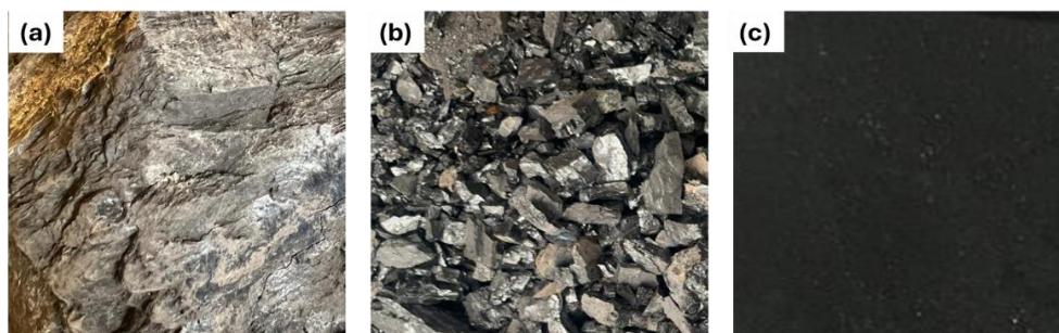
Gambar 2.3 Bahan baku penelitian (a) batubara sub-bituminus, (b) cacahan batubara, dan (c) batubara 100 mesh.
