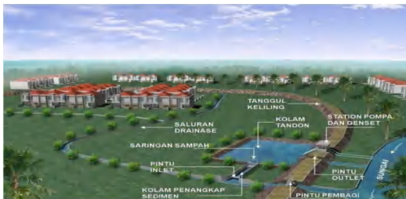
Gambar 8 Sistem polder dengan pompa dan kolam di samping badan saluran/Sungai
