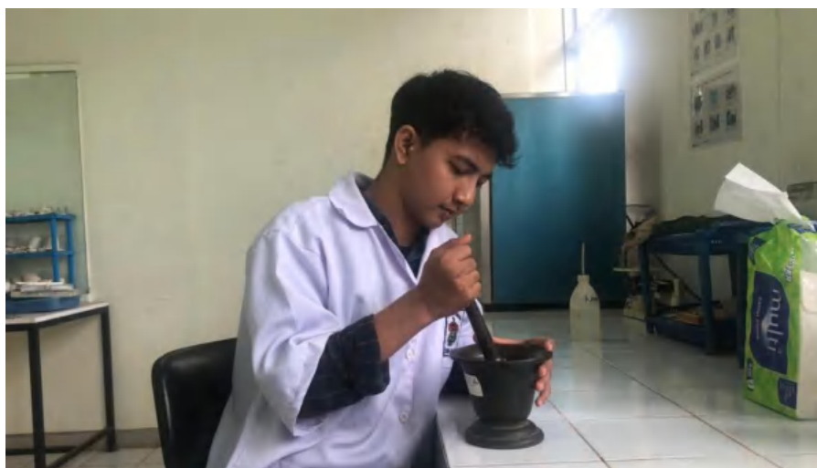
Gambar 3. Tahapan reduksi ukuran sampel menggunakan mortar
