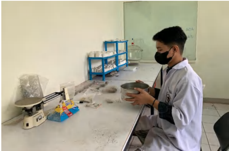
Gambar 4. Tahapan pengayakan sampel menggunakan ayakan 200 mesh
