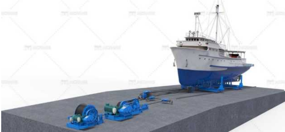
Gambar 1. Ilustrasi gambar docking kapal menggunakan winch (Asmara, 2020)
