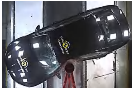
Gambar 1. Ilustrasi uji tabrak samping pada mobil ( www.euroncap.com )
