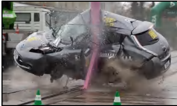
Gambar 1. Ilustrasi uji tabrak samping pada mobil ( www.euroncap.com )
