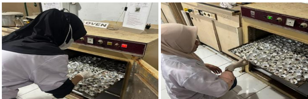
Gambar 5. Pengeringan sampel di dalam oven pada suhu 80°C selama 24 jam
