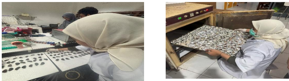
Gambar 5. Preparasi dan pengeringan sampel di dalam oven pada suhu 100°C
