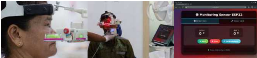
Gambar 2. 5 Proses penentuan kesejajaran dengan alat fox plane modifikasi
