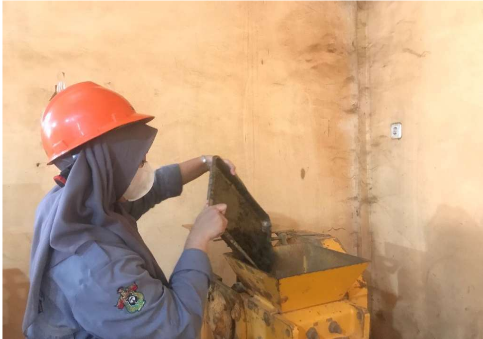
Gambar 8. Mereduksi ukuran sampel dengan jaw crusher
