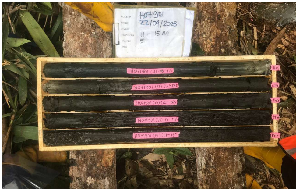
Gambar 4. Sampel pengeboran diambil untuk analisis XRF dan XRD
