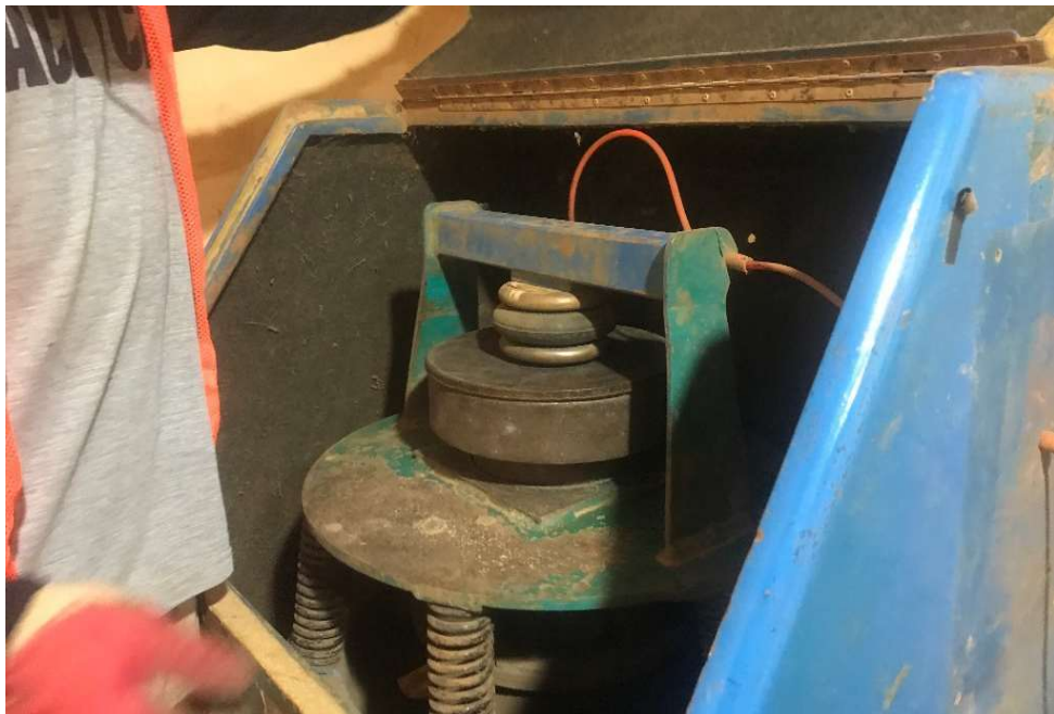
Gambar 9. Mereduksi ukuran sampel dengan pulvirizer
