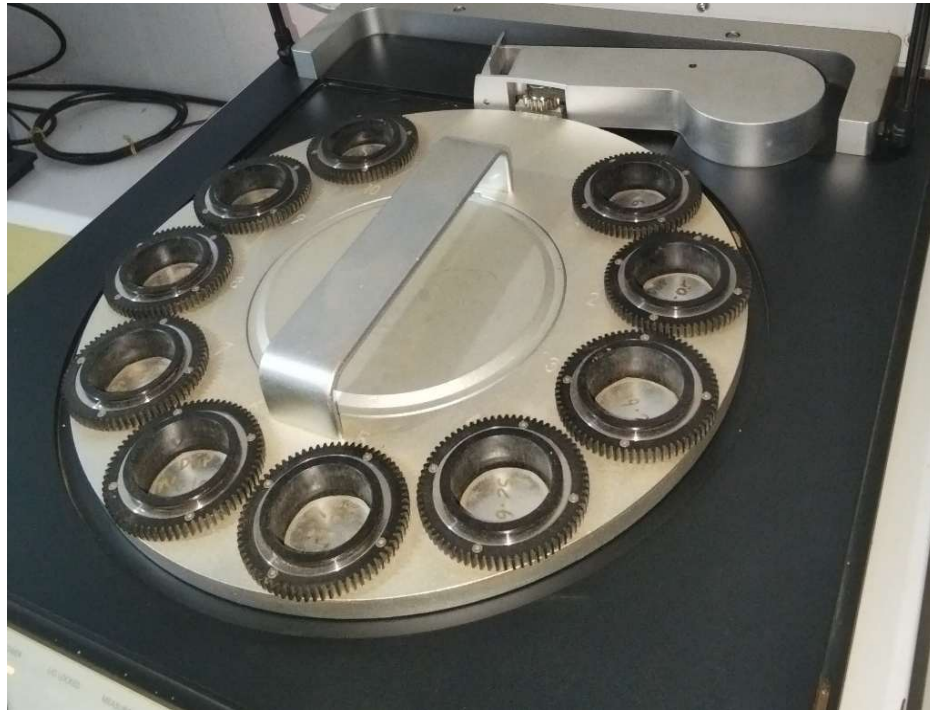
Gambar 13. Melakukan analisis XRF sampel pengeboran
