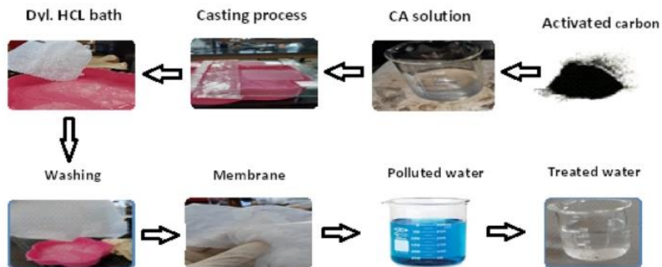
Gambar 8. Mekanisme composite membrant adsorbent
