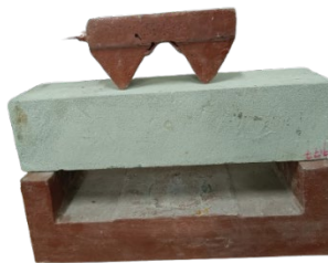
Gambar .21. Gambaran Benda Uji Ditekan dengan 2 Titik Pembebanan
