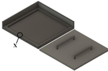
Gambar 18 Desain cetakan panel Matriks
