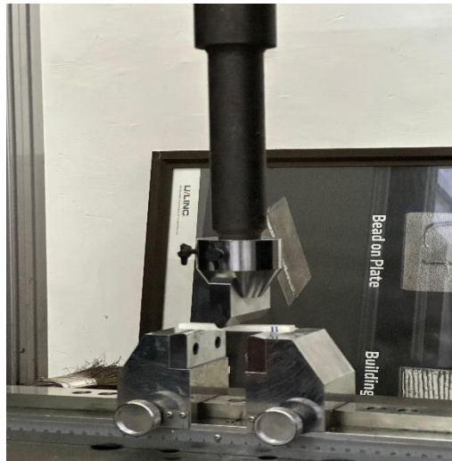
Gambar 21 Langkah Pengujian Bending
