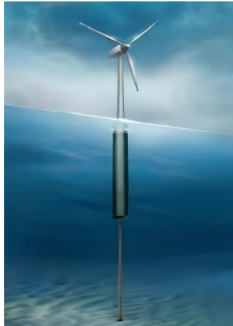
Gambar 4. Sistem tambat tension leg (Karimirad, 2011)
