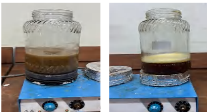
Gambar 2.2. Proses Hidrolisis dan Delignifikasi pada pemisahan selulosa
