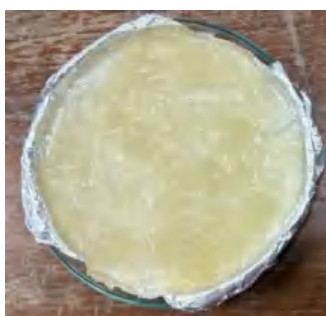
Gambar 2.4. Hasil Bleaching selulosa dengan \text{H}_2\text{O}_2
