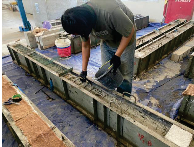
Gambar 2.10. Proses pemberian surface treatment pada benda uji
