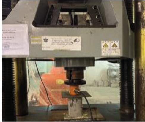
Gambar 2.16. Pengujian kuat tekan beton
