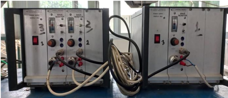
Gambar 21. Wave monitor dilengkapi dengan kabel penghubung.
