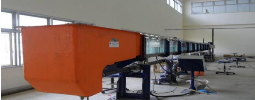
Gambar 18. Saluran pembangkit gelombang ( Armfield S6 MKII tilting flume )
