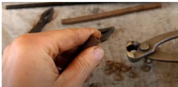
Gambar 7. Pembentukan dan Pemotongan Kawat Besi
