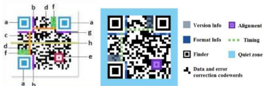
Gambar 1. Stuktur Dasar QR Code
