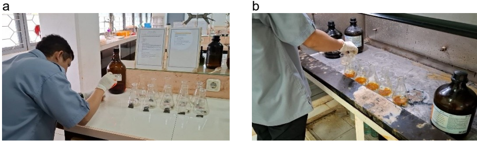
Gambar 9. (a) preparasi sampel dan persiapan proses titrasi, (b) proses titrasi pada sampel tanah.
