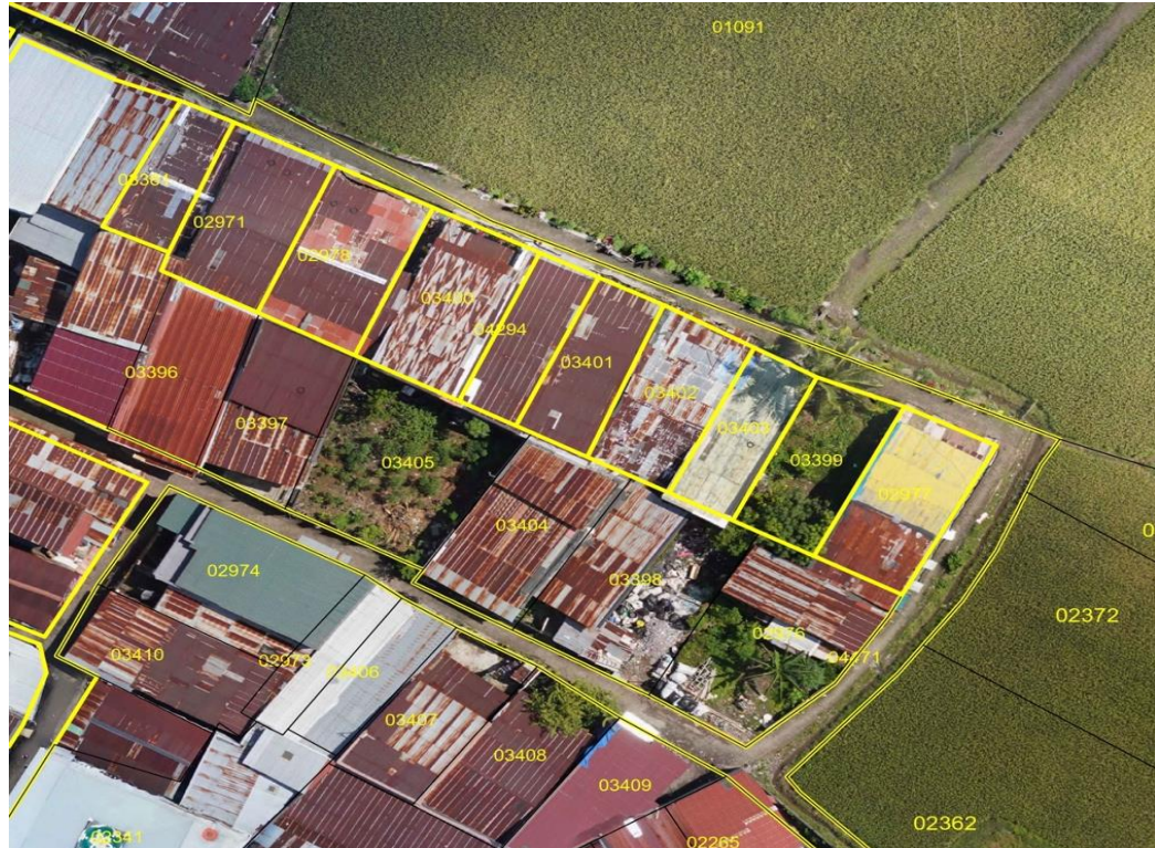
Gambar V. Pengukuran Bidang Tanah dengan menggunakan metode Fotogrametris Kelurahan Batangkaluku, Kecamatan Somba Opu
