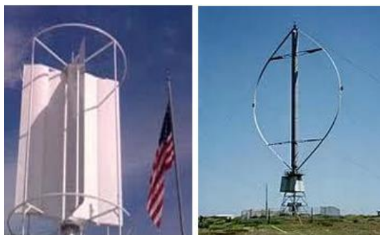
Gambar 2. Turbin angin sumbu vertikal (Bachtiar & Hayyatul, 2018)
