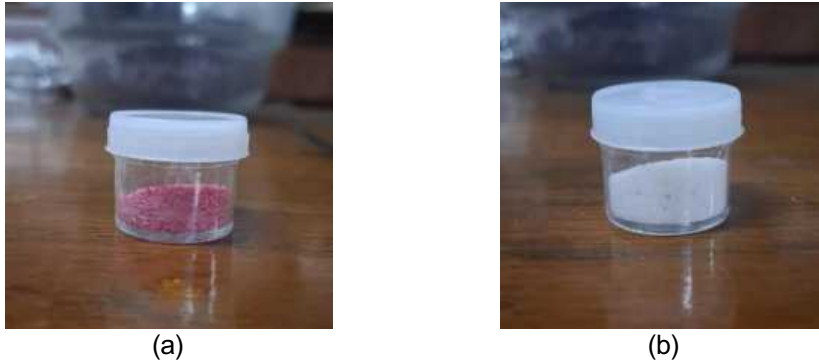
Gambar 1. Material (a) MIP yang belum diekstrak dan (b) MIP yang telah diekstrak
