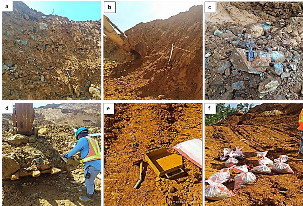
Gambar 9. Tahapan pengambilan sampel saprolit di area pit (a). Kenampakan face mining dengan material saprolit. (b) Pengambilan sampel saprolit dengan bucket excavator. (c) Fraksi kasar dan halus material saprolit. (d) Pengambilan sampel material saprolit di bucket excavator. (e) Perlengkapan sampling scope 120D. (f) Material saprolit yang sudah disampling dan dipacking dikirim ke sample house .
