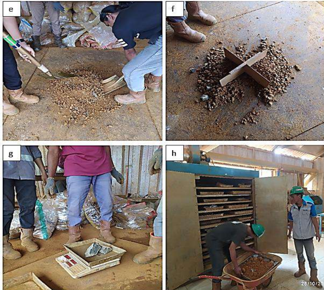
Gambar 11. Tahapan lanjutan preparasi basah (e) mixing sampel untuk homogenisasi. (f) sampel kuartir. (g) penimbangan kembali masing-masing fraksi. (h) pengeringan sampel dalam oven.
