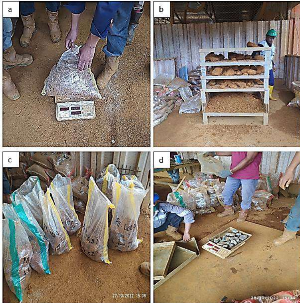
Gambar 10. Tahapan preparasi sampel saprolit (a) penimbangan sampel saprolit dari face mining/stockpile, (b) screening sampel material saprolit (-2",+2",+4",+6",+8"), (c) pengelompokan masing-masing fraksi, (d) penimbangan kembali masing-masing fraksi.
