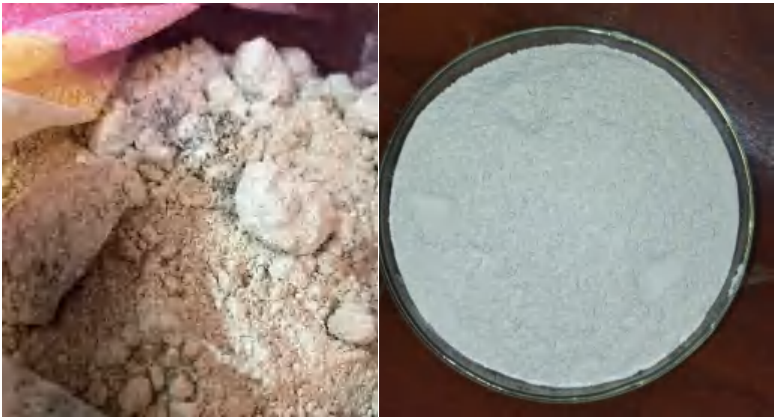
Gambar 2.1. Mineral alam Toraja Utara, a) sebelum preparasi b) setelah preparasi
