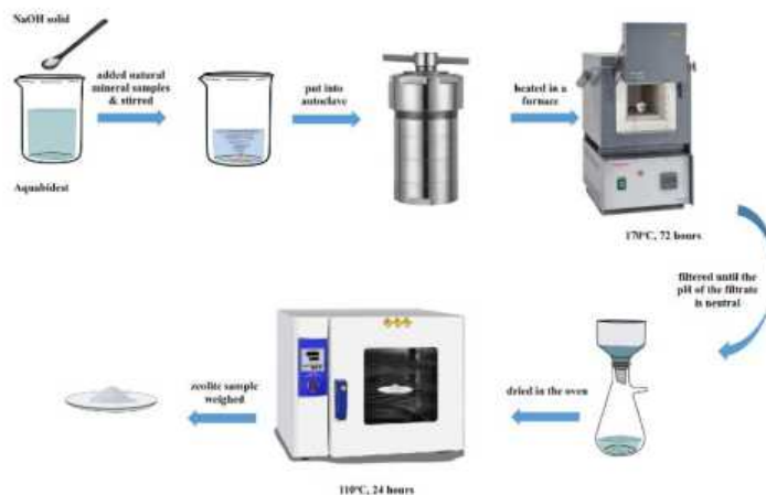
Gambar 2. 2 Prosedur sintesis zeolit dari mineral alam Toraja Utara
