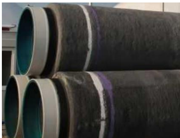
Gambar 1.8 Coating pada pipa bawah laut
