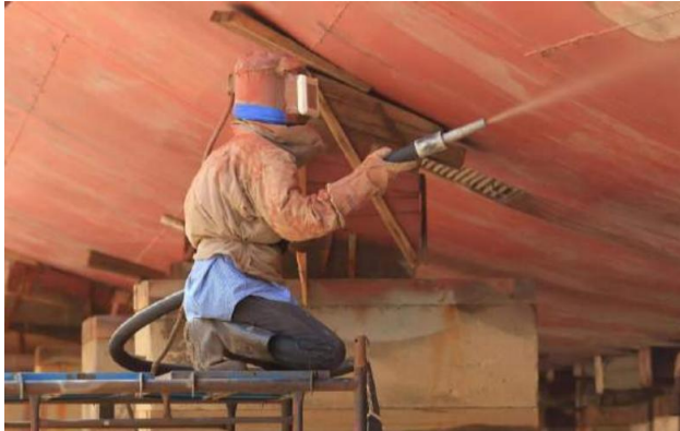
Gambar 2. Proses sandblasting lambung kapal (sumber: Dokumentasi pribadi)
