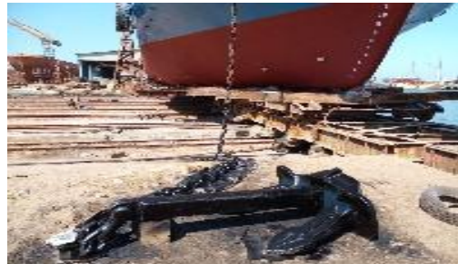
Gambar 5. Perawatan Jangkar Dan Rantai Jangkar (Sumber: Dokumentasi pribadi)
