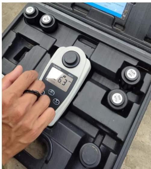
Gambar 10. Pengukuran menggunakan turbidity
