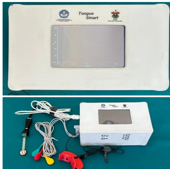
Gambar 18. Perangkat elektromiografi Tongue Smart
