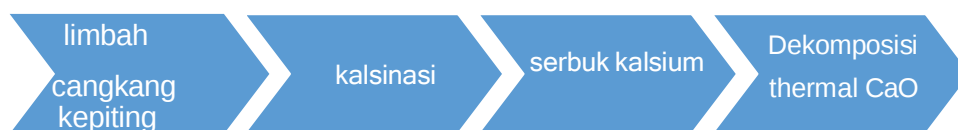
Gambar. 2.2 Prosedur pembuatan hidroksiapatit cangkang kepiting
