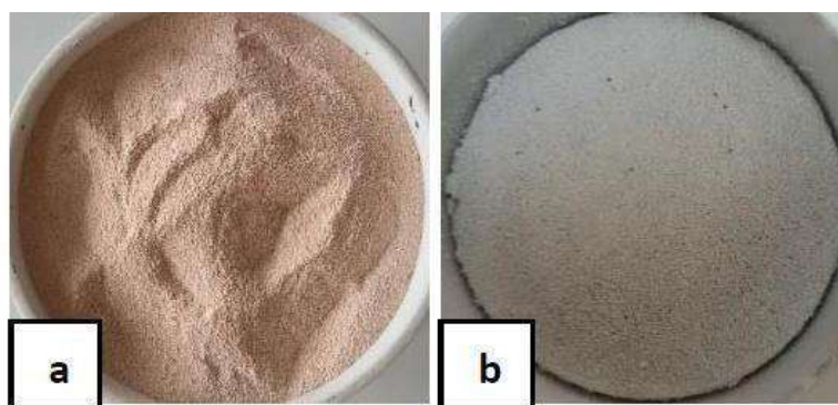
Gambar 1. 3 Cangkang kepiting sebelum kalsinasi (a) dan setelah kalsinasi (b)
