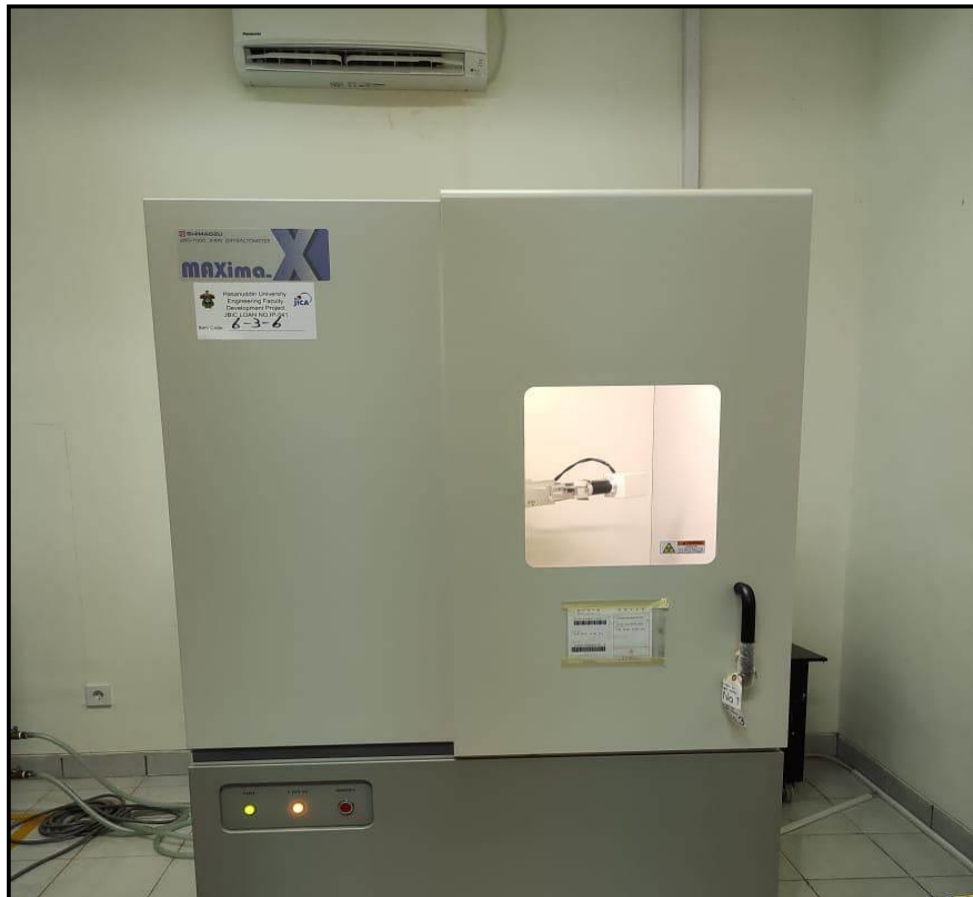
Gambar 3.6 X-Ray Diffractometer yang digunakan untuk menganalisis mineral
