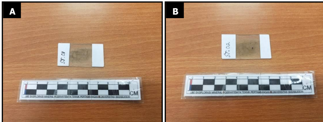
Gambar 3.4 A. Sayatan Tipis Sampel Stasiun 1 dan B. Sayatan Tipis Sampel Stasiun 2
