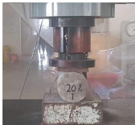
Gambar 20. Pengujian Kuat Tarik Belah Beton.
