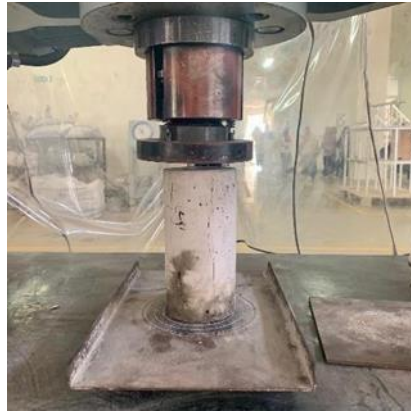
Gambar 12. Pengujian Kuat Tekan
