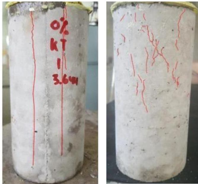
Gambar 33. Pola retak columnar
