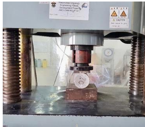
Gambar 13. Pengujian Tarik Belah
