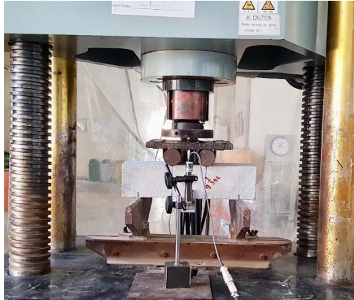
Gambar 14. Pengujian Kuat Lentur
