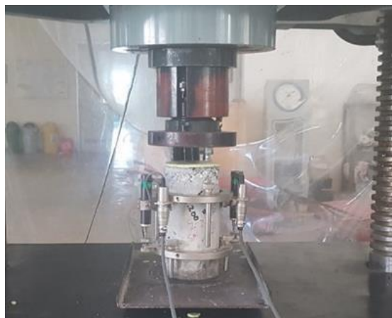
Gambar 18. Pengujian Kuat Tekan dan Modulus Elastisitas Beton
