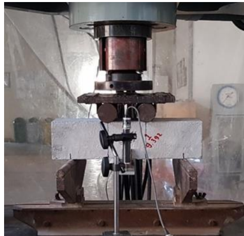
Gambar 22. Pengujian Kuat Lentur Beton
